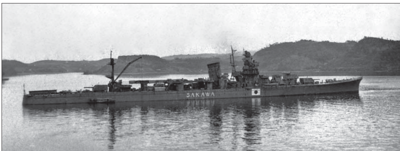
«Сакава» 15 октября 1945 г. Зенитная артиллерия (8-см пушки и 25-мм автоматы) демонтированы, но главный калибр еще на месте. Также видны антенны всех трех типов РЛС. Корабль несет идентификационную марку в виде японского флага и надпись латиницей на борту. На вертикальных поверхностях выше палубы (башни, мостик, труба, опоры самолетной платформы) заметен камуфляж
