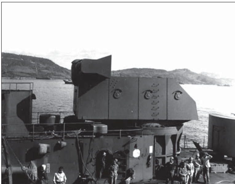
«Сакава». Разоруженная носовая возвышенная башня с дальномером. Послевоенное фото. Обратите внимание на рынду, подвешенную на надстройке прямо под башней, и параван в левом нижнем углу снимка
