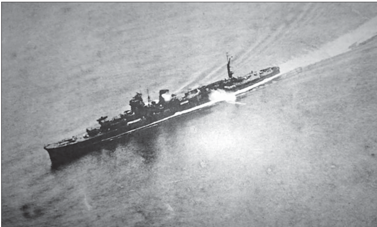
«Агано» на учениях в районе атолла Трук, 7 декабря 1942 г. На фото запечатлен пуск торпеды из кормового торпедного аппарата. Артиллерийские установки главного калибра развернуты на левый борт
