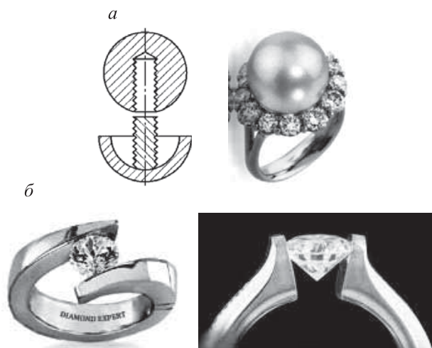
Рис. 10.25. Закрепка жемчужины (а) и упругая закрепка (б)
