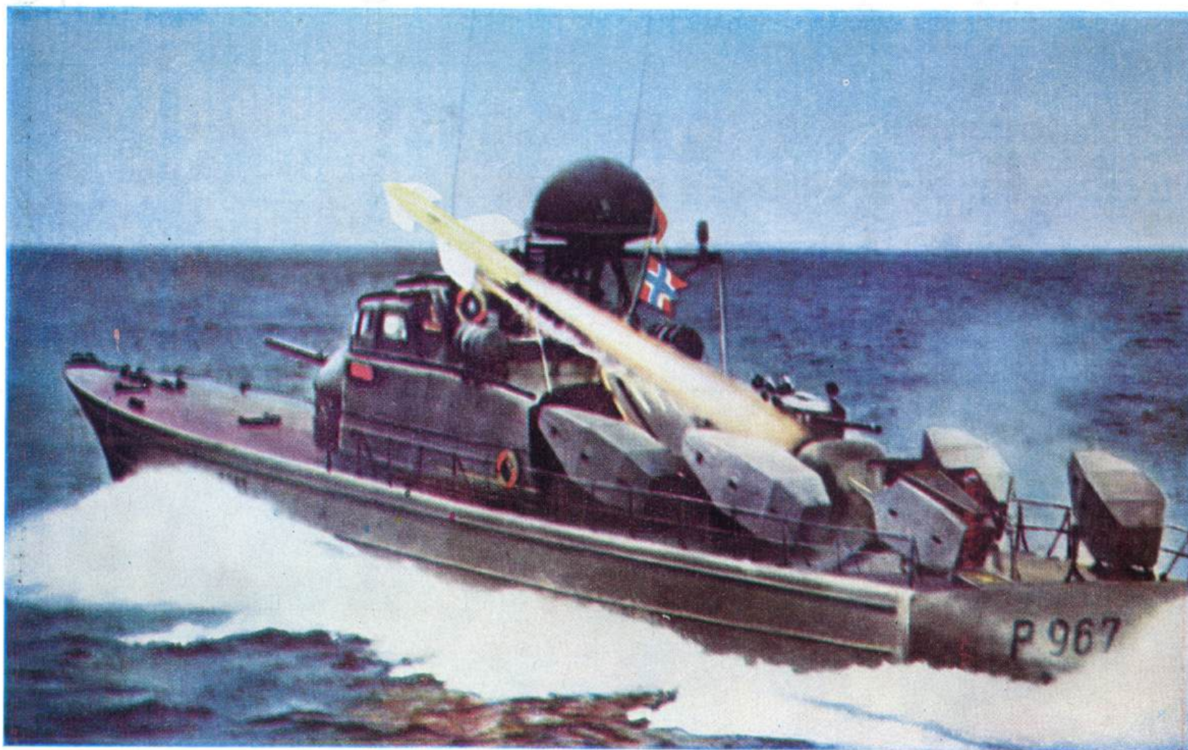
НОРВЕЖСКИЙ РАКЕТНЫЙ КАТЕР Р967 «СКЮДД» (типа «Сторм»). Его стандартное водоизмещение 100 т, полное 125 т; длина 36,5 м, ширина 6,2 м, осадка 1,3 м; мощность главной энергетической установки 7200 л. с. (два дизеля); наибольшая скорость хода 36 уз; вооружение — шесть пусковых установок для УР «Пингвин», 76- и 40-мм универсальные артустановки. Экипаж 20 человек
