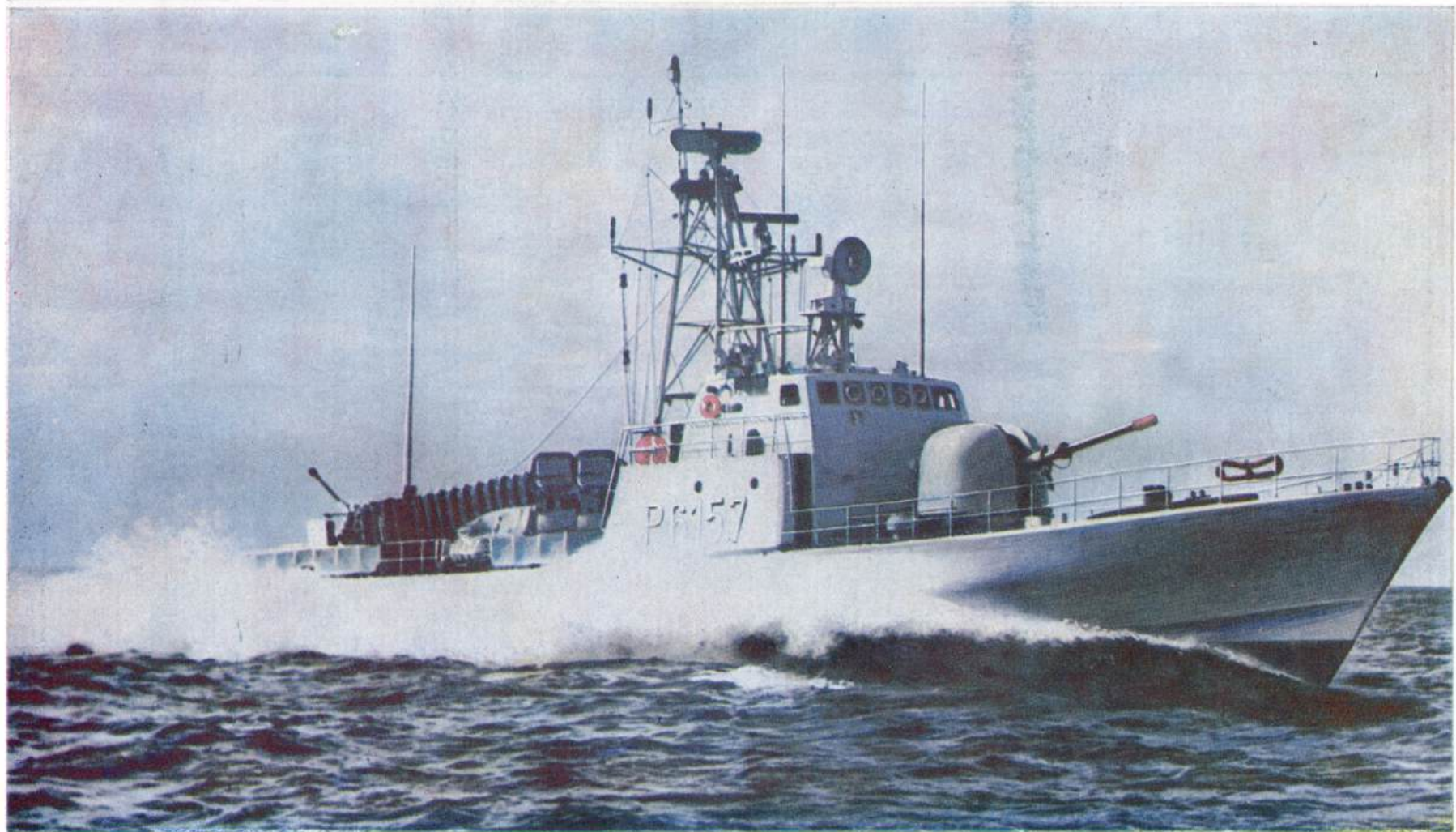
ЗАПАДНОГЕРМАНСКИЙ РАКЕТНЫЙ КАТЕР Р6157 „ВАИ“ проекта 148 введен в боевой состав флота в 1975 году. Его стандартное водоизмещение 234 т, полное 265 т, длина 47 м, ширина 7 м, осадка 2 м, мощность энергетической установки (четыре дизеля) 14 000 л. с., наибольшая скорость хода 38 уз, дальность плавания при скорости хода 30 уз 600 миль, вооружение – четыре пусковые установки для противокорабельных ракет „Экзосет“ 76- и 40-мм арт-установки, может брать на борт мины. Экипаж 30 человек, в том числе четыре офицера.
