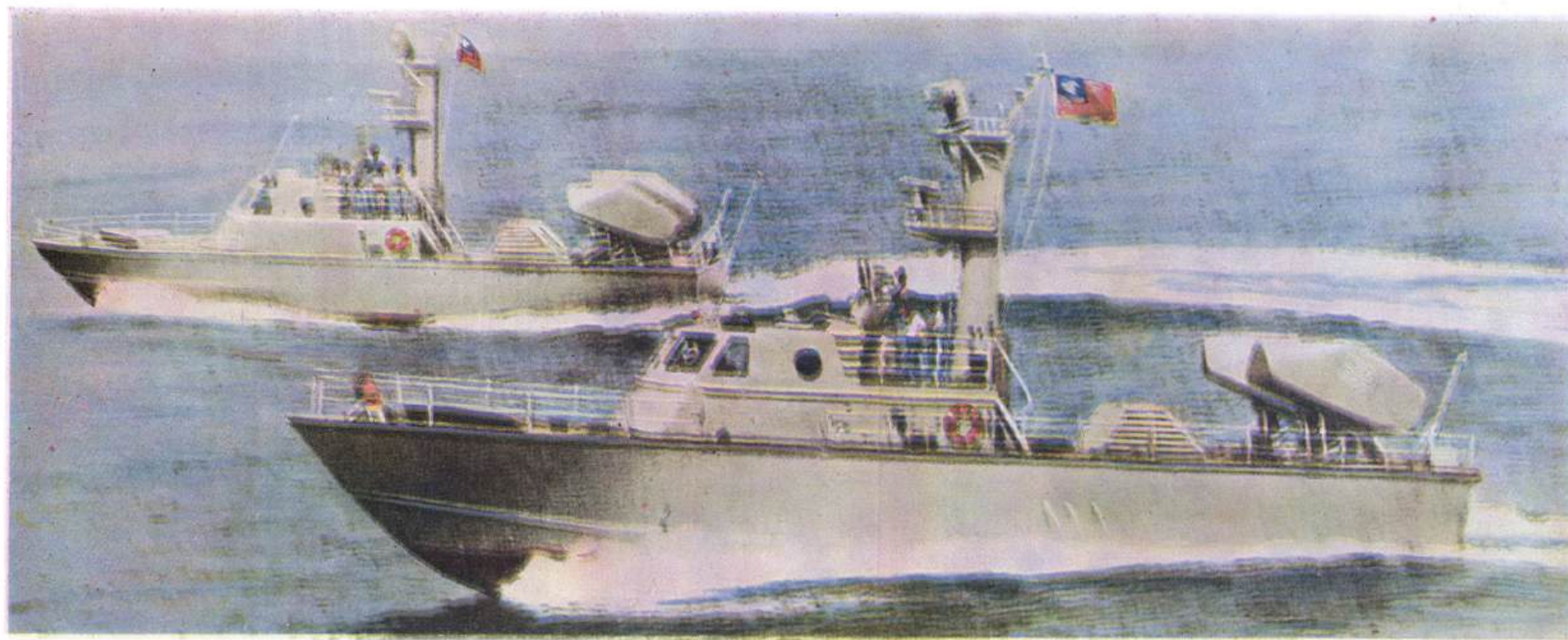
РАКЕТНЫЕ КАТЕРА ТИПА „ХАЙОУ“ (50 единиц) военно-морских сил гоминьдановцев на Тайване. Тактико-технические характеристики катера водоизмещение 47 т длина 21,6 м, ширина 5,5 м, осадка 1 м; мощность двухвальной дизельной энергетической установки 2720 л. с., наибольшая скорость хода 36 уз, дальность плавания 700 миль при скорости 32 уз; вооружение — две одноконтейнерные пусковые установки для противокорабельных ракет „Сюн Фэн“ (дальность стрельбы около 40 км) 20-мм артиллерийская установка и два 12,7-мм пулемета. Экипаж десять человек.
