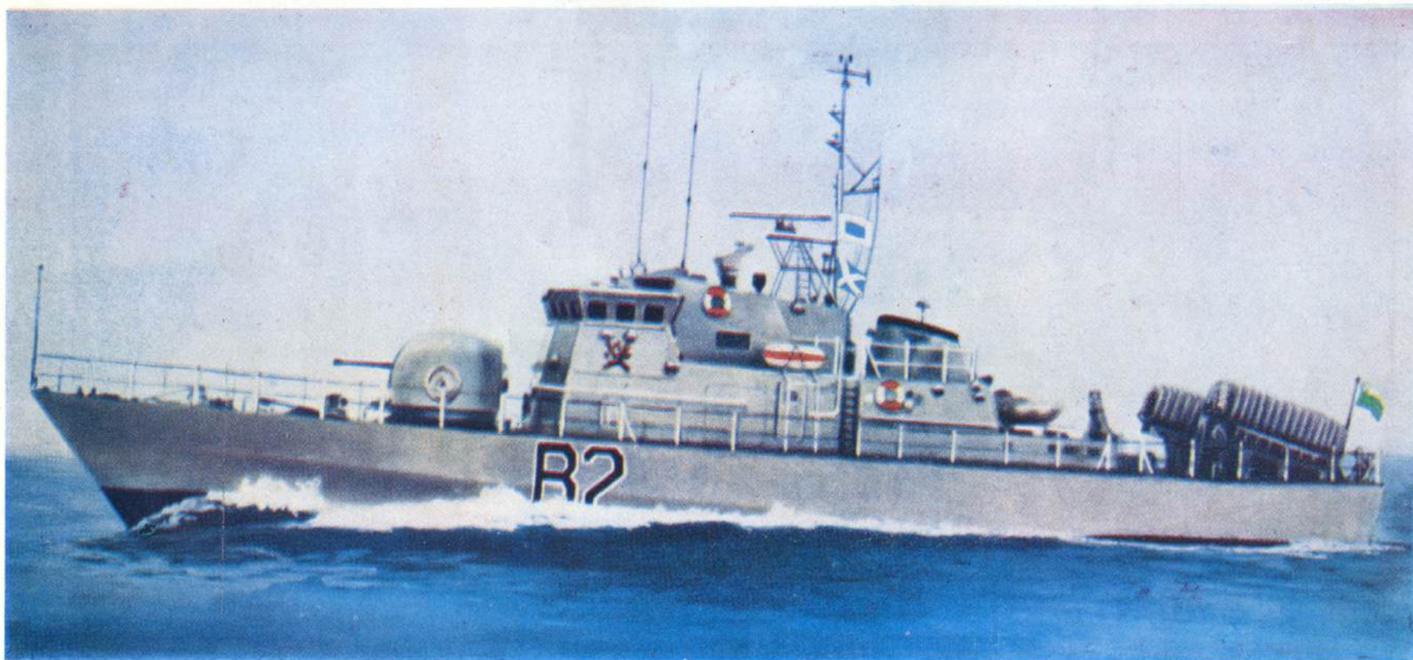
РАКЕТНЫЙ КАТЕР В2 «АЛЬ-МАНСУР» ВМС ОМАНА введен в боевой состав флота в 1973 году. Его танкико-технические характеристики: стандартное водоизмещение 135 т, полное 153 т; длина 37,5 м, ширина 6,9 м, осадка 1,7 м; мощность главной энергетической установки 4800 л. с.; наибольшая скорость хода 29 уз; дальность плавания 3300 миль при скорости 15 уз; вооружение — две пусковые установки для УР «Экзосет», 76-мм артустановка, два 40-мм зенитных автомата. Экипаж 27 человек, из них три офицера
