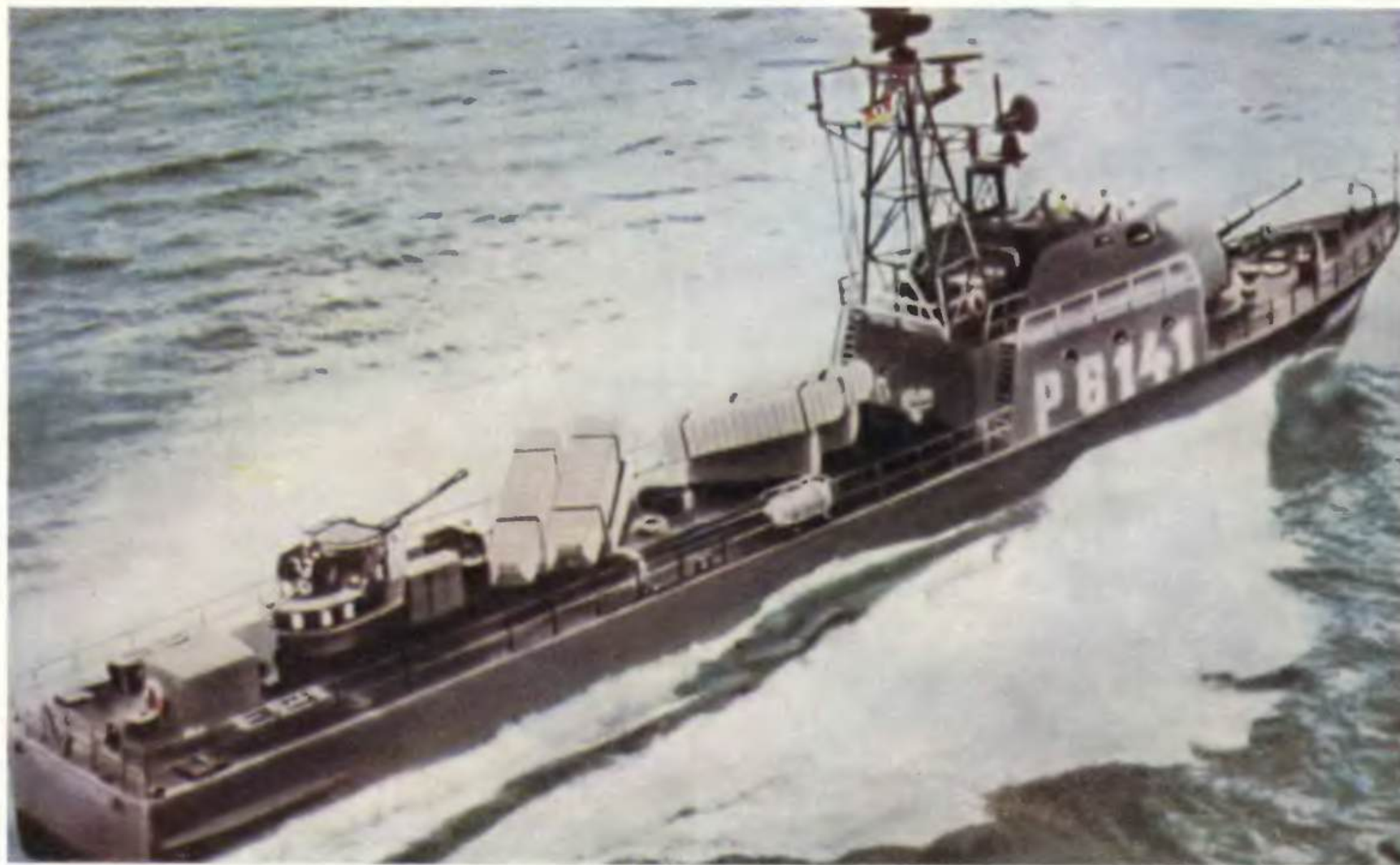
Западногерманский ракетный катер P6141 проекта 148. Его водоизмещение стандартное 234 т, полное 265 т, длина 47 м, ширина 7 м, осадка 2 м; мощность энергетической установки (4 дизеля) 14 000 л. с.; максимальная скорость хода 38,5 узла; дальность плавания при скорости 30 узлов 600 миль; вооружение — система УРО «Экзосет» (четыре пусковые установки), 76-мм универсальная артиллерийская установка и 40-мм зенитный автомат. Экипаж 30 человек, из них четыре офицера.
