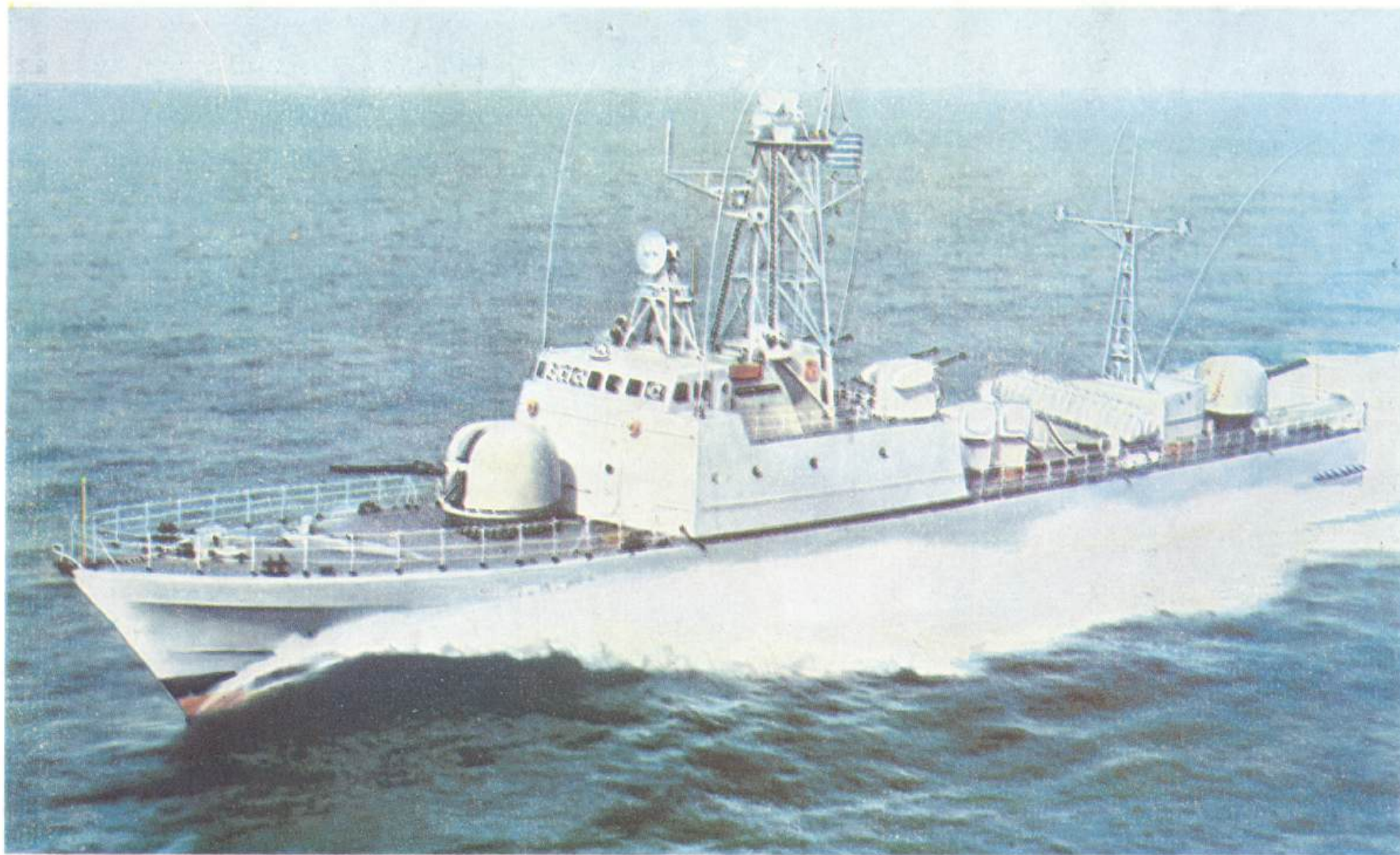
ГРЕЧЕСКИЙ РАКЕТНЫЙ КАТЕР Р20 «АНТИПЛИАРХОС ЛАСКОС» — головной из десяти единиц в серии — введен в боевой состав флота в 1977 году. Его стандартное водоизмещение 385 т, полное 425 т; длина 56,2 м, ширина 8 м, осадка 2,1 м; мощность энергетической установки (четыре дизеля) 18 000 л. с.; наибольшая скорость хода 36 уз; дальность плавания 2000 миль при скорости хода 15 уз; вооружение — четыре пусковые установки ПКРК «Экзосет», две 76-мм одноорудийные универсальные башенные артиллерийские установки, две 30-мм двухствольные артиллерийские установки, два 533-мм однотрубных торпедных аппарата. Экипаж 42 человека, в том числе пять офицеров.
