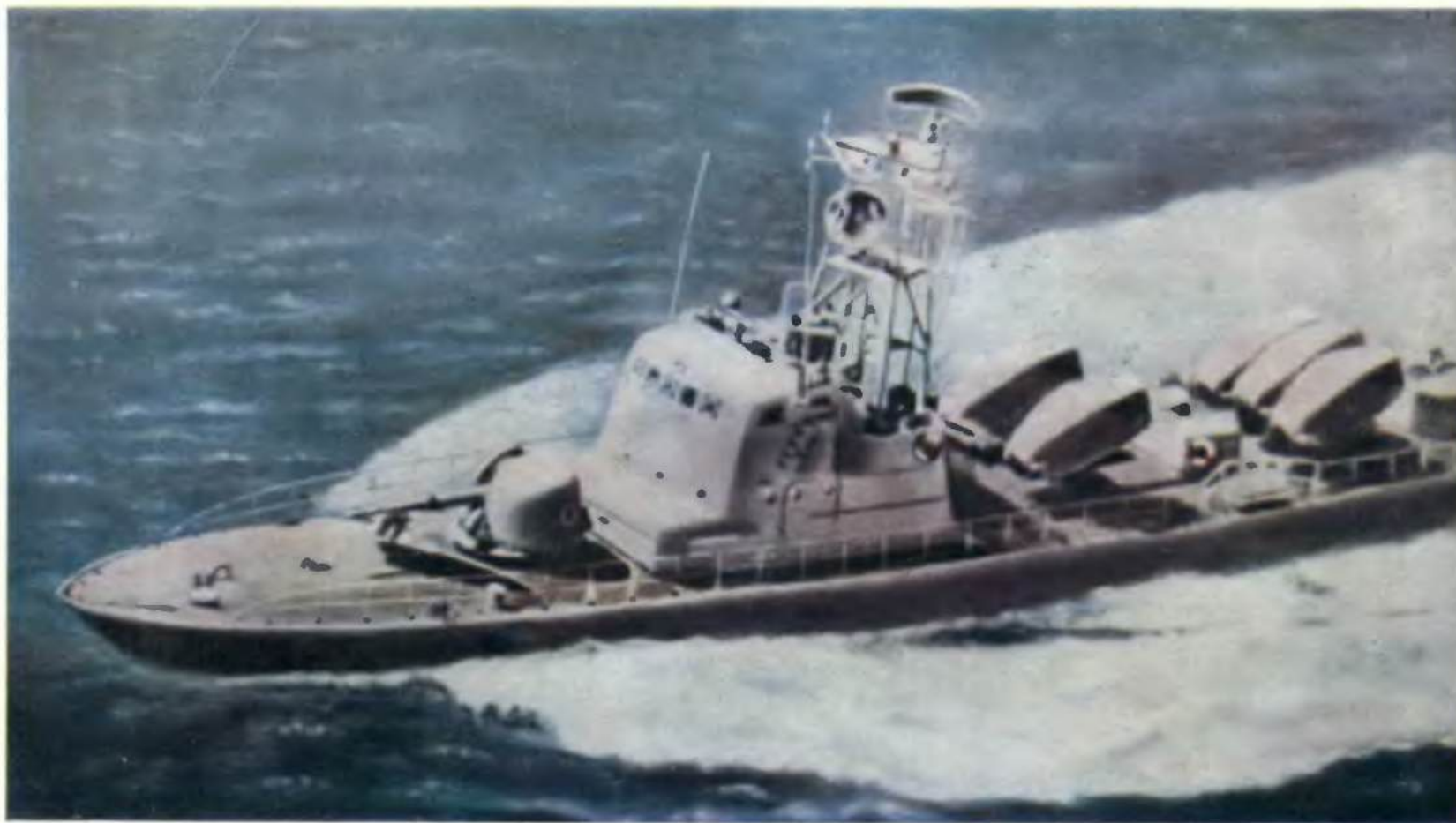
Израильский ракетный натер типа «Саар». Водоизмещение стандартное 220 т, полное 250 т; длина 45 м, ширина 7 м, осадка 1,8 м; мощность энергетической установки (четыре дизеля) 13 500 л. с.; скорость хода до 45 узлов; дальность плавания при скорости 30 узлов 1000 миль, при скорости 20 узлов — 1600 миль; вооружение: система УРО «Габриэль», 76-мм артустановка или 40-мм автомат; экипаж 40 человек.
