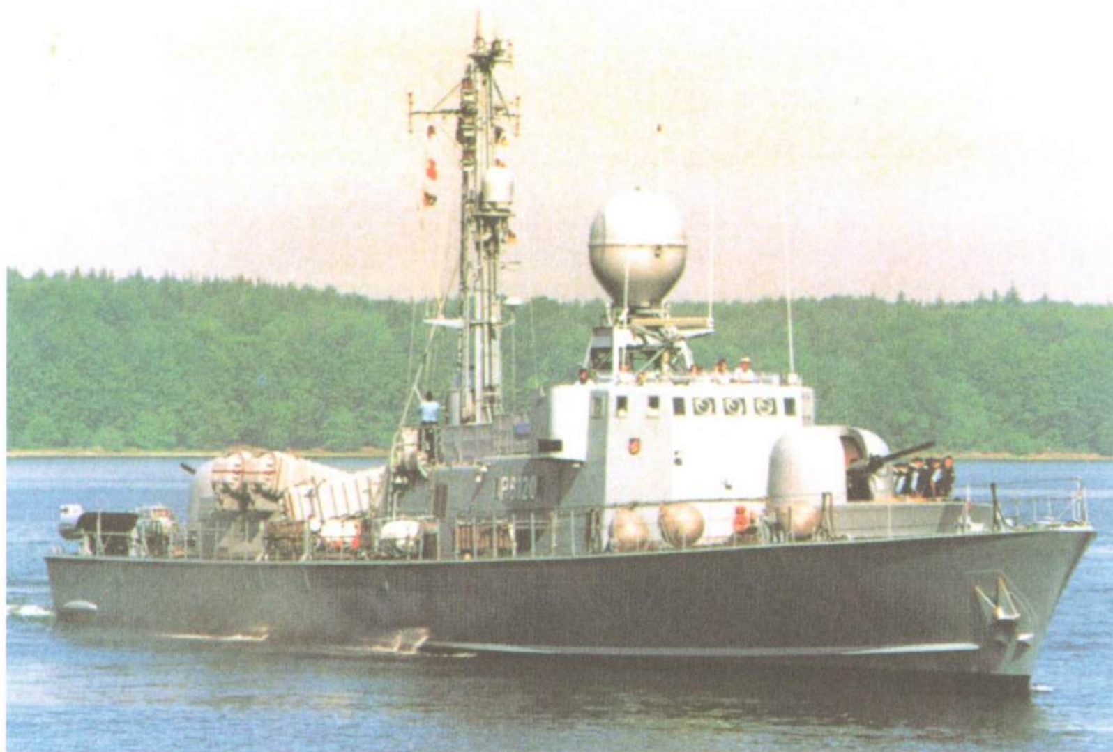
РАКЕТНЫЙ КАТЕР Р6120 «КОРМОРАН» типа «АЛЬБАТРОС» (проект 143В) ВМС ГЕРМАНИИ – последний в серии из десяти катеров. В состав боеготовых сил флота вошел 29 июля 1977 года. Корпус изготовлен из дерева с оклейкой углепластиком. Его основные тактико-технические характеристики: полное водоизмещение 398 т, длина 57,6 м, ширина 7,8 м, осадка 2,6 м. Четырехвальная дизельная главная энергетическая установка мощностью 17 700 л. с. позволяет развивать максимальную скорость хода 40 уз. Дальность плавания 1 300 миль при скорости 30 уз. Вооружение: две спаренные ПУ ПКР «Экзосет» ММ 38 (дальность стрельбы 42 км, скорость полета ракеты M=0,9 , масса боевой части 165 кг, система наведения инерциальная и активная радиолокационная), две 76-мм АУ «ОТО Мелара», два 12,7-мм пулемета (могут устанавливаться при необходимости), два 533-мм ТА. Экипаж 40 человек, из них четыре офицера.
